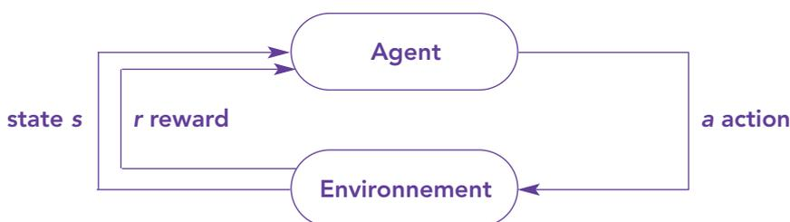
Figure 1 : Schéma de principe de l'apprentissage par renforcement
